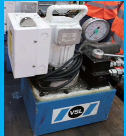
● PE554油泵车 等张千斤顶用。小流量可精确控制应力
