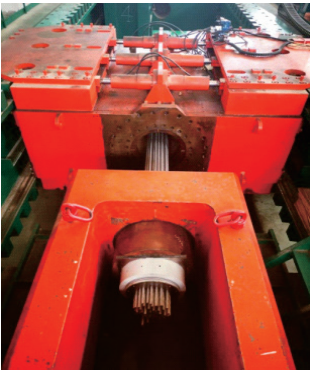
55孔高强度钢绞线拉索组件疲劳验证试验
